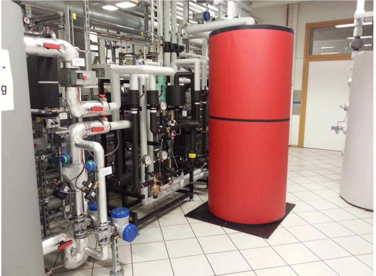
Abb. 3.69 Versuchsstand: Zweistufiges Speicherladesystem (FÜS6)
