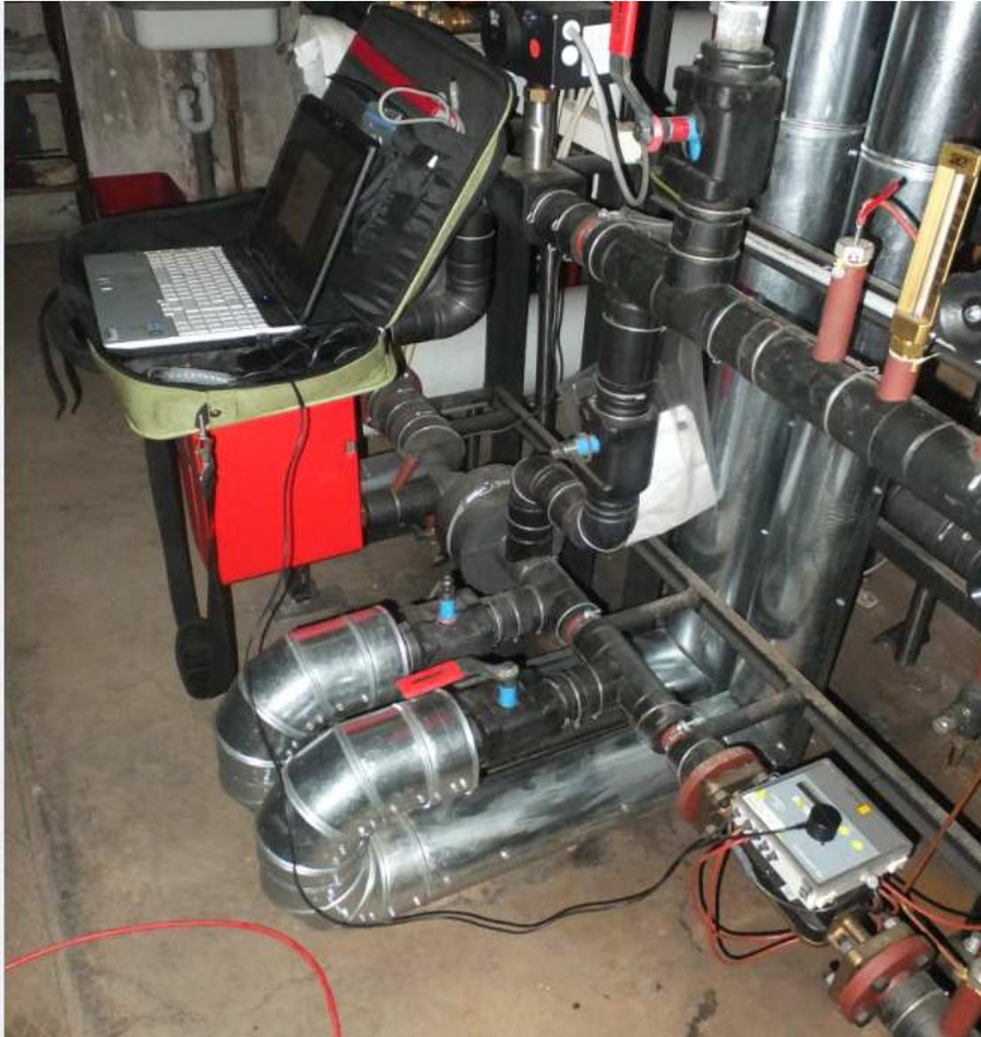
Abb. 4.5 Laptop über Optokoppler mit Wärmemengenzähler UH 50 verbunden
