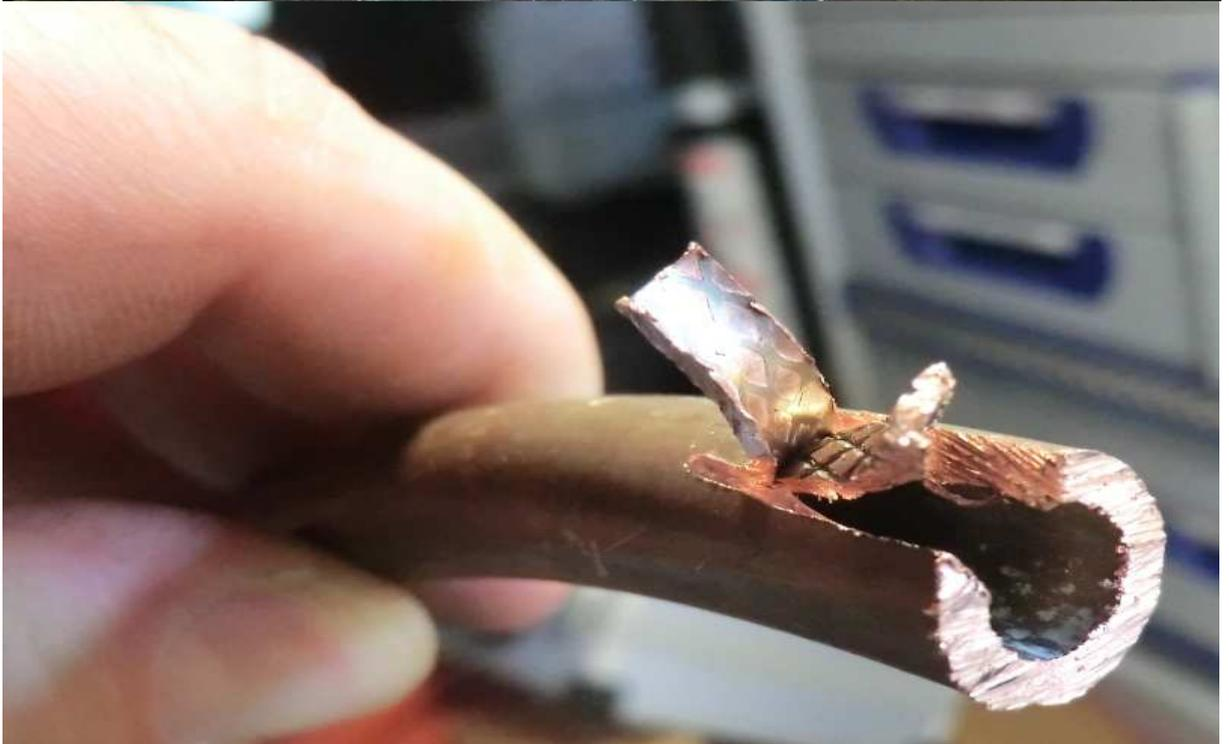
Abb. 3.61 Schnitt durch den Koaxialwärmeübertrager und Detail des doppelwandigen Kupferrohres
