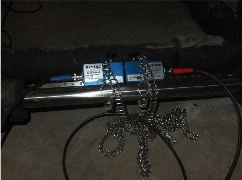
Abb. 4.10 Mit Spannketten auf abisolierte Rohrleitung montiertes Durchflussmessgerät
