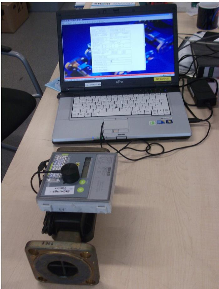
Abb. 4.3 Auslesung eines Wärmemengenzählers UH50 mit Optokoppler und Laptop
