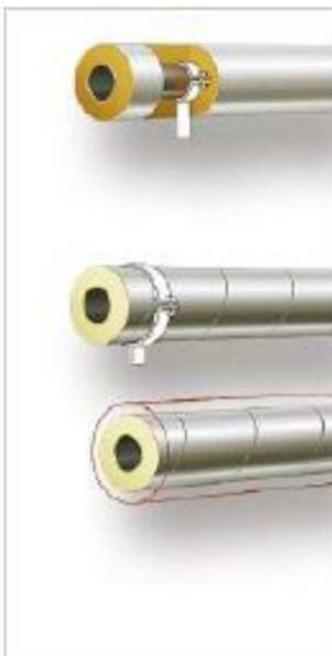
Das obere Rohr auf Abb.3.20 zeigt den herkömmlichen Dämmstandard, wobei die Isolierung um die Rohrschellen herum montiert werden muss und zu Wärmebrücken führt.
